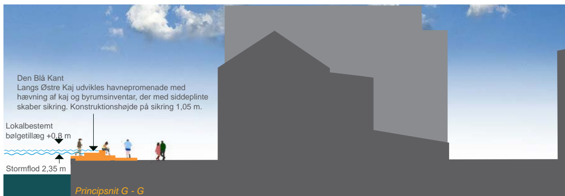
Variant 2 - sikringsmur med byrumsinventar
