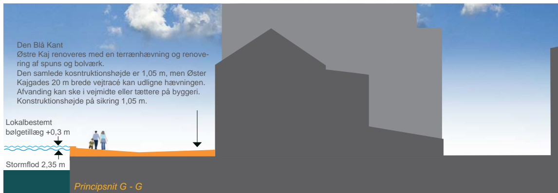
Variant 1 - forhøjning af kajkanten
